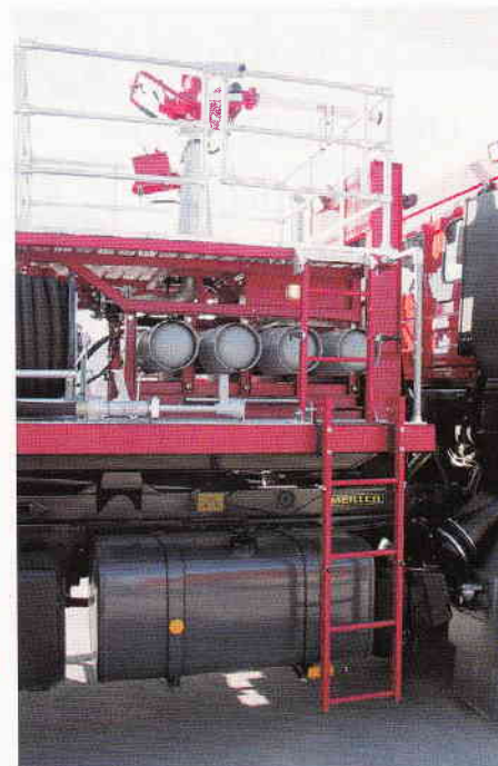
Aufstieg zum Arbeitspodest über Leiter. Automatische Beleuchtung der Trittflächen beim Abklappen der Leiter.
