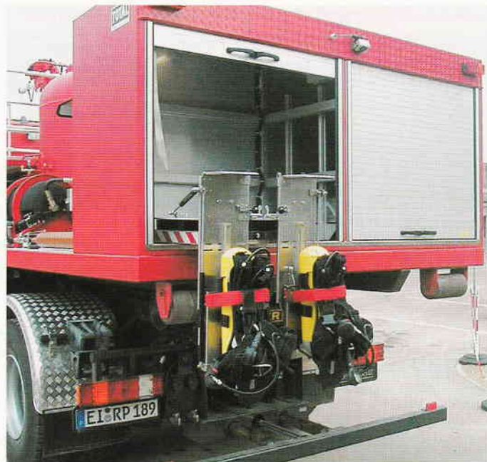
Geräteraum mit zwei Atemschutzgeräten auf Drehschlitten. Eine Klappvorrichtung ermöglicht ein Entnahmemmaß von 120 cm. Oben Bildmitte: Rückfahrkamera mit 100° Bildwinkel.
