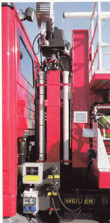
Lichtmast 2 x 1.000 Watt bis 4,10 m ausfahrbar. Strahler über Joysticksteuerung horizontal und vertikal schwenkbar und mit Endschalter gegen Fehlbedienung gesichert. Stromversorgung über feste Verdrahtung mit Dynawatt Anlage und zusätzliche Steckdosen für weitere Verbraucher.
