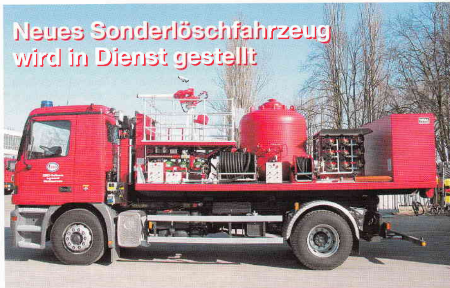
Neues Sonderlöschfahrzeug wird in Dienst gestellt Trockenlöschfahrzeug 2.000 kg Pulver, 270 kg Kohlendioxid auf Wechsellader. Trägerfahrzeug Mercedes-Benz Actros 1831, Automatik Getriebe mit Meiller Abrollkipper Typ RK14.55
