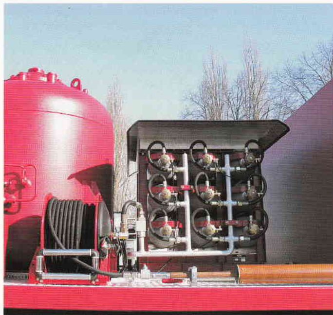
Kohlendioxid Löschanlage mit Bedienstation und Schnellangriffseinrichtung. Schlauchhaspel mit 45-m-Schlauch DN 16 und Schneerohr (Ausstoß 50 kg/min.).
