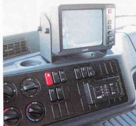
Sieben Zoll Monitor für Rückfahrkamera schaltet sich automatisch zu, sobald der Rückwärtsgang eingelegt wird. Darunter: Bedientableau für Dynawatt Anlage.
