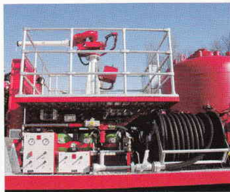
Pulverlöschanlage mit 2.000 kg schaumverträglichem Löschpulver. Schnellangriffseinrichtung/Schlauchhaspel mit 40-m-Schlauch DN 32 und Pulverrohr (Ausstoß 5 kg/sec.). Pulverwerfer (Ausstoß 40 kg/sec.) mit abgesetzter Bedienstation.
