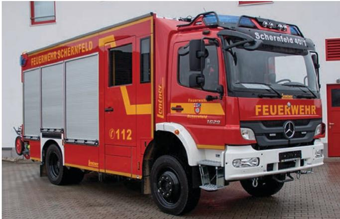
**Hilfeleistungslöschgruppenfahrzeug (HLF 20)
