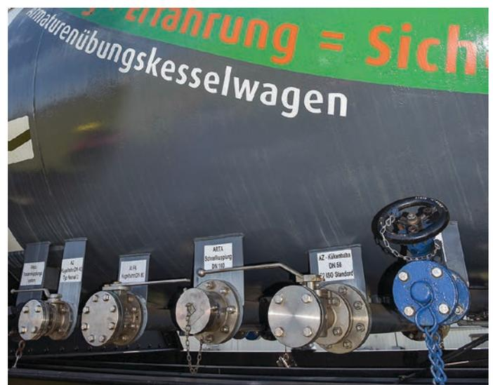
Typische Anschlüsse an Kesselwagen verschiedener Bautypen.
