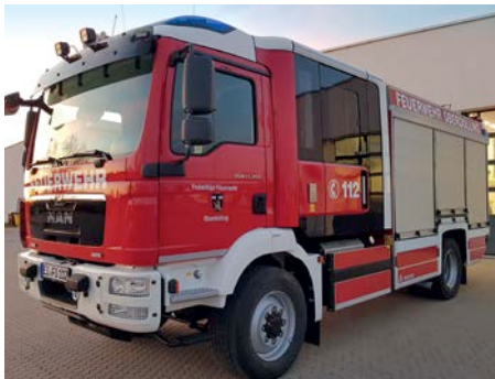
Hilfeleistungs-Löschgruppenfahrzeug (HLF 20) der Feuerwehr Oberdolling
